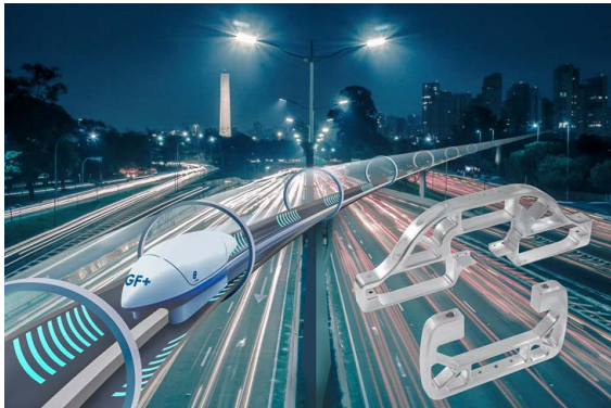
2017 stellte Swisloop seinen Pod «Escher» vor. Für die Kapsel entwickelte GF eine Fahrwerkskomponente aus Aluminium.
