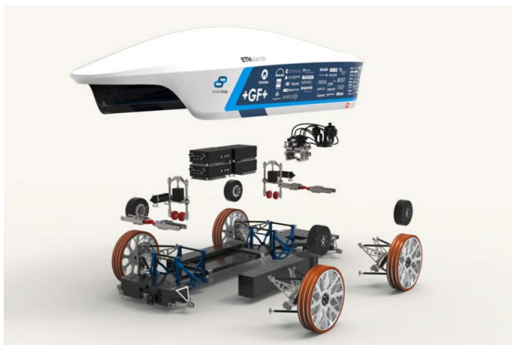
Der Pod 2018 wird von vier Elektromotoren angetrieben, ist 540 PS-stark und soll bis zu 500 Stundenkilometer schnell sein.
