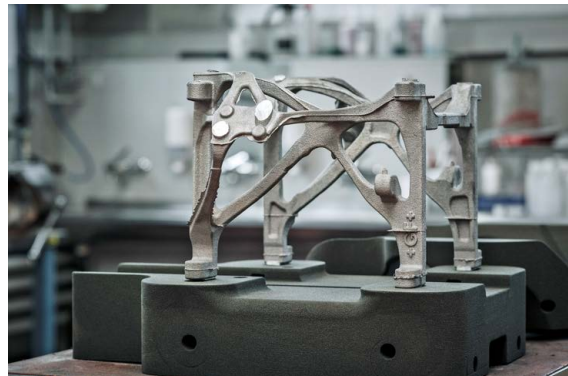
Die beiden Achsträger sorgen für die Stabilität des Pod-Chassis. Sie sind jeweils 35 cm hoch, 30 cm breit und 55 Zentimeter lang und wiegen jeder für sich nur fünfeinhalb Kilogramm.
